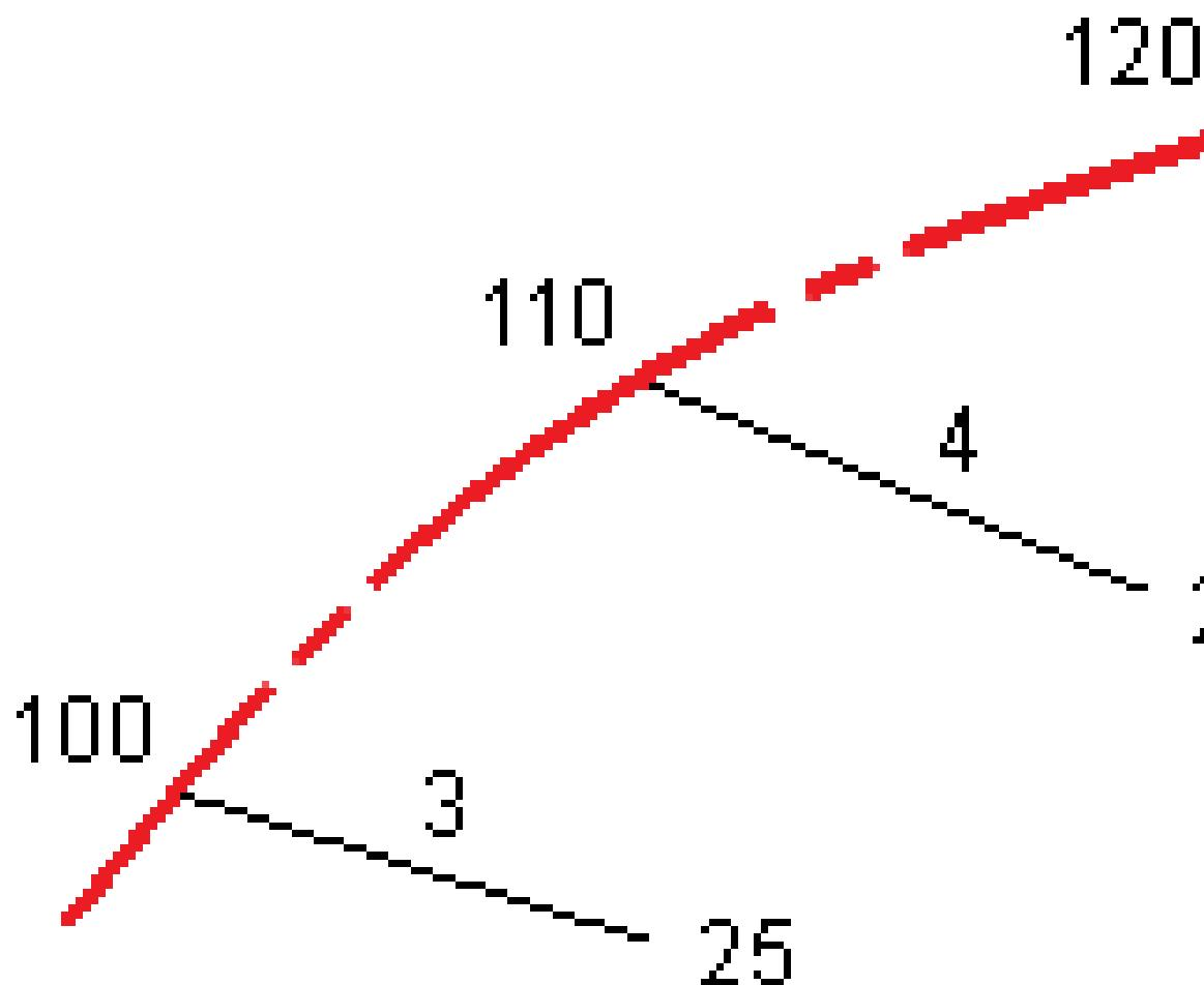
しかし、3Dストリングの偏差角が関連付けされた6Dストリングと比較され、その差が30分以上ある場合は、関連付けされた6Dストリングのジオメトリは無視され、その代わりに座標は線形補間によって算出されます。これは、左折専用レーン、バス停留所などのフィーチャーにより3Dストリングで急な方向転換があったとき予期しない動きを避けるためです。
